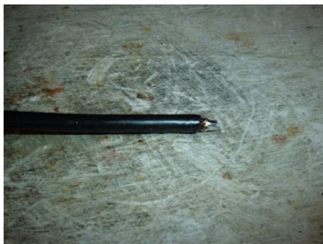
Die Induktivität wird dann am Anschlussende des eigentlichen Strahlers parallel angeschlossen und beide Kabel mittels eines Stück Schrumpfschlauch parallel fixiert. Wichtig ist,genau darauf zu achten,daß beim Anfertigen des Stubs die Länge genau von der Kurzschlussstelle bis zum anderen Ende(Anschlussseite) auf 35mm bemessen wird.
