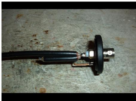
Zum Schluss wurden nur noch die Übergänge am Kabel wie oben genannt isoliert und das Gehäuse verschlossen und mit Sekundenkleber verklebt.
