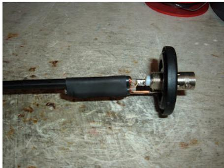
Nun wurde das Kabel an der BNC Buchse mit dem Innenleiter verlötet und mittels eines Stück 2mm Kupferdraht der Außenleiter angeschlossen.
