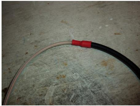
Das erste Stück,daß ich anfertigte,war der 35mm(incl.Kurzschlusslötstelle ab der Unterkante der Außenisolation gemessen-OHNE die Anschlussseite die später mit der Antenne verbunden wird) lange Koaxteil der später die erforderliche zusätzliche Induktivität darstellt.
